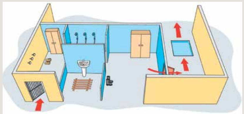
Figure 2. Schéma général d'un sas sanitaire avec douche et changement de tenue complète.
