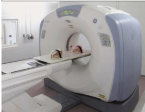
Acquis dans le cadre du programme de développement de Hubbard, le tomographe permet d'évaluer le rendement en viande sur les différentes parties du poulet avec des résultats très proches de la réalité, tout en gardant l'animal en vie.
