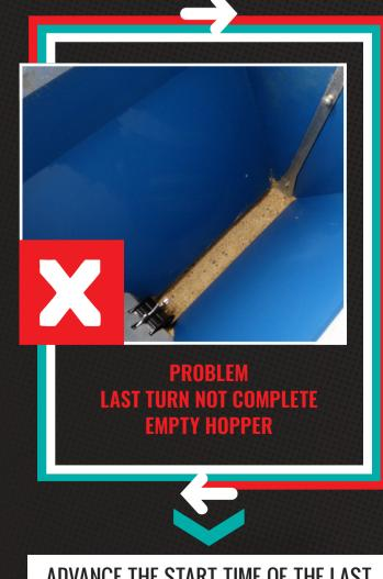
**DELAY THE TIME** OF THE LAST FEED ADVANCE THE START TIME OF THE LAST FEED. DO NOT ADJUST THE FEED LEVEL
