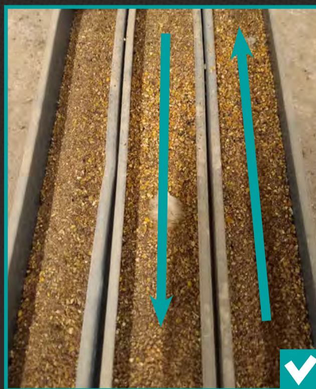
Fig. 2 - S'assurer que le niveau d'aliment est identique sur les différents circuits d'alimentation.
